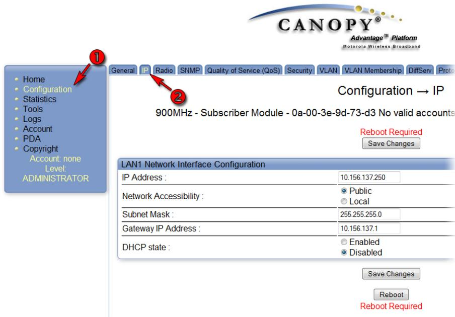
**FIG 3.2-4. MOTOROLA CANOPY SM IP CONFIGURATION**
